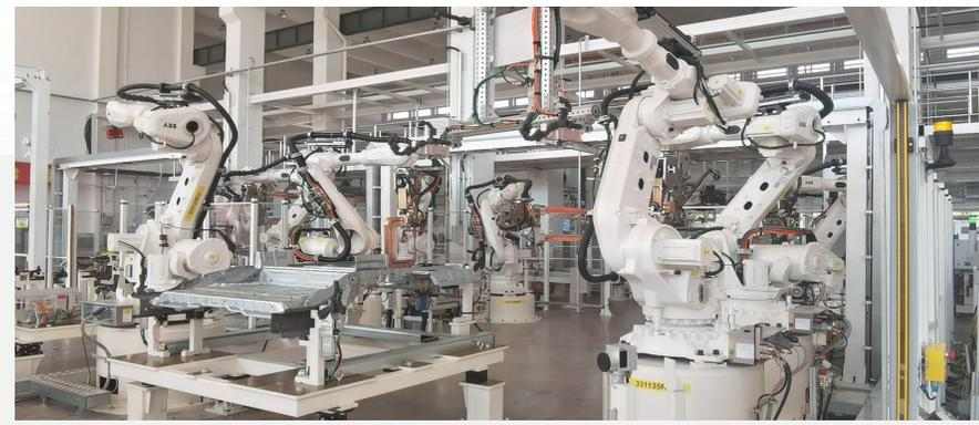
**一线：**以未来工厂数字化生产为主的——智能制造无人工厂焊装生产“线”，主要生产红旗轿车E115车型和C905车型中后底板。
