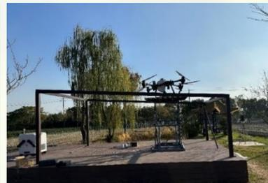
飞防中心利用可见光及红外无人机检测技术对茶园草害、墒情、病虫害、茶叶产量、茶树生长情况进行实时监测，指挥植保无人机，自动采茶机器人等机械进行联动工作。单一机组可监测面积为2500亩，作业面积可达500亩
